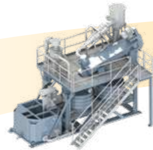
Hydrocyclone Séparation densimétrique
