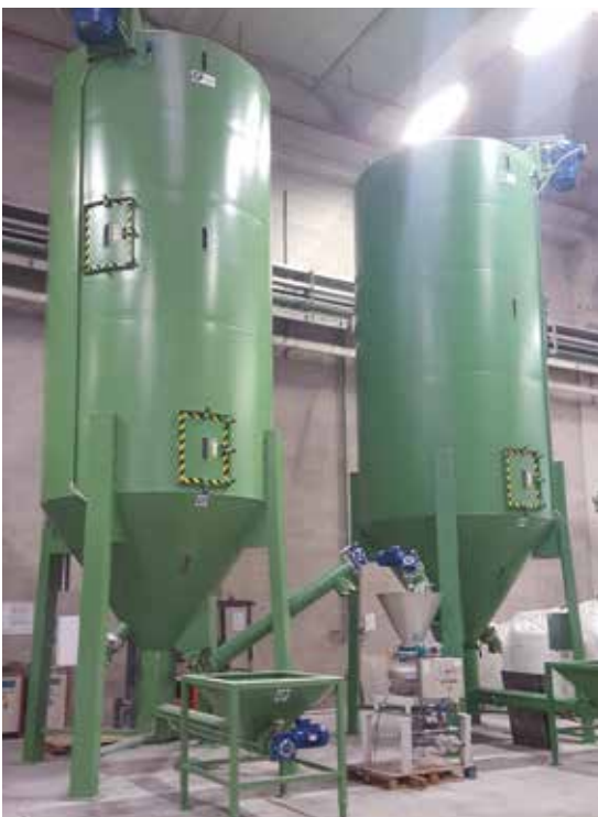
Silos en acier peint ou acier inox à partir de 1 m 3 Installation en intérieur, montage sur pieds et trémie d'alimentation forcée
